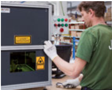
Lézerrel történő logógravírozás.
