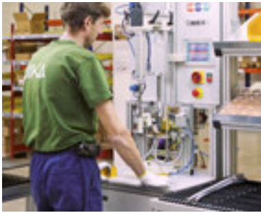
Levegőteszt az összeszerelő soron.
