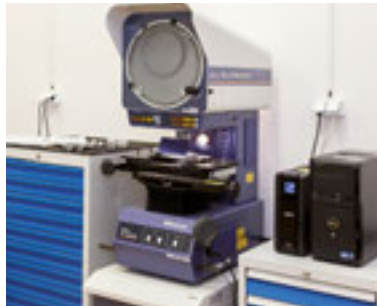
Profil projektor. Minőség-ellenőrzési laboratórium.
