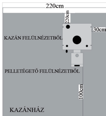
2. számú ábra Kazán megfelelő elhelyezése a kazánházban
