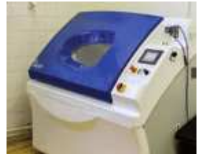
Korróziós kamra az extrém körülményszimulálásához az anyagvizsgálatok számára.
