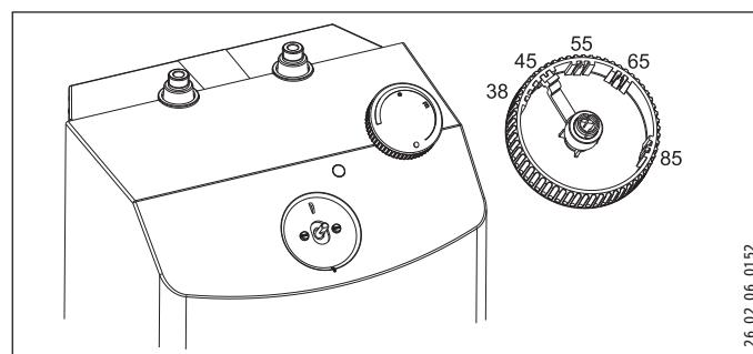
Pomocou páky pod otočným regulátorom teploty môžete obmedziť nastaviteľný rozsah otočného regulátora teploty na maximálnu teplotu.
