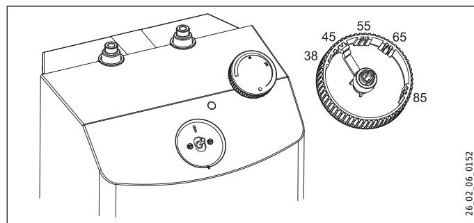
Mit dem Hebel auf der Unterseite des Temperatur-Einstellknopfes können Sie den Einstellbereich des Temperatur-Einstellknopfes auf eine maximale Temperatur begrenzen.
