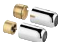
7458000-00 fordítóadapter egykaros előlappal szerelt KLUDI FLEXX.BOXX egységhez fordított hideg/meleg vízbekötéshez
