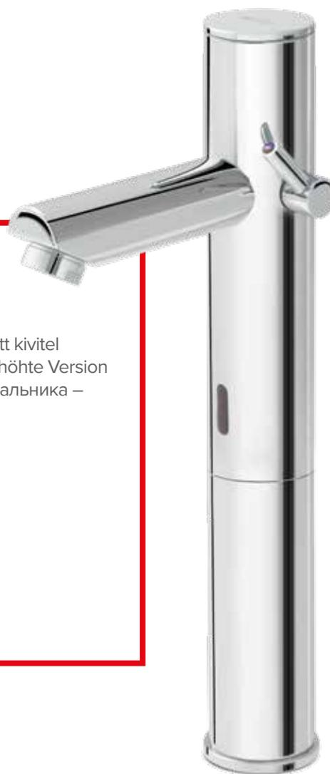
/ FRESH IR hideg vagy fix hőmérsékletű meleg vízhez; elemes vagy hálózati üzem 9V/230V, elektronikus programozással.
