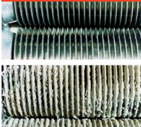
Alumínium roncsolódás vizsgálat, 3000 órás üzem
