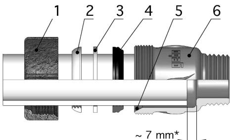
**D** \* Einbaulänge beachten! Rohre dürfen nicht bis zum Anschlag eingeführt werden bzw. bei Kupplungen nicht aneinander stoßen.
